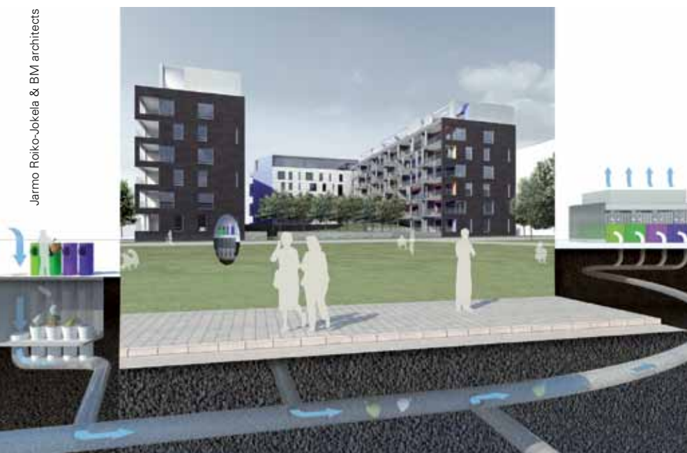
Jätkäsaaren ja Kalasatamaan tulee jätteiden putkikuljetusjärjestelmä.
